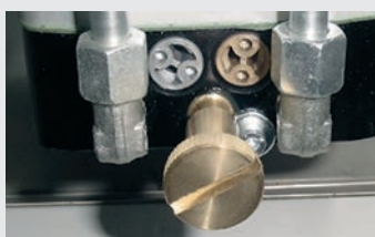
Regulacja siły za pomocą zaworów by-pass
