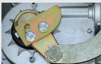
Regulowany ogranicznik mechaniczny podczas otwierania i zamykania
