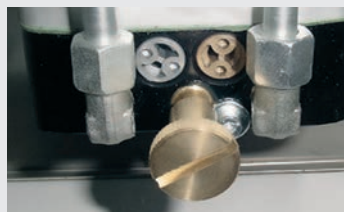
Regulacja siły za pomocą zaworów by-pass
