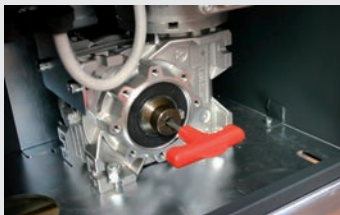
Odblokowanie za pomocą personalizowanego klucza
