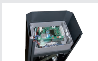
Elektroniczna centrala sterująca umieszczona na górze szlabanu
