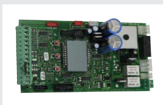
USER 1 - 24V DG - centrala sterująca DG 24V z wyświetlaczem LED i zintegrowanym światłem ostrzegawczym
