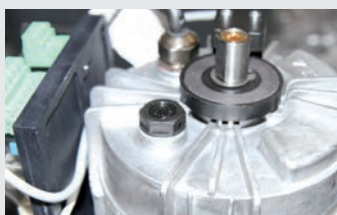
Silnik elektryczny i przekładnia w kąpielii olejowej
